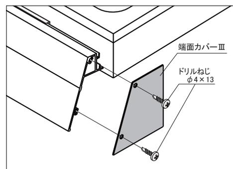
② 端面カバーⅢが動かないように確実に押えた状態で、端面カバーⅢのビス穴2箇所ドリルねじ2本を取付け固定してください。
