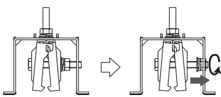
横側のナットは、ハゼ幅に合わせて締める量を調節して下さい。この時、ナットが外れないように注意してください。
