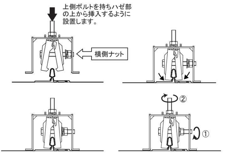
金具がズレないように横側ナットを手で仮固定します。
