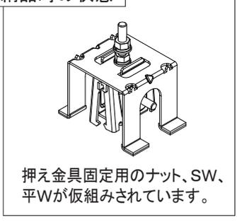
①-1 屋根材に取り付ける際に使用する押え金具固定用のナット、SW、平Wを各1個ずつ取り外し、更にその下のナットを軽く緩めてください。
