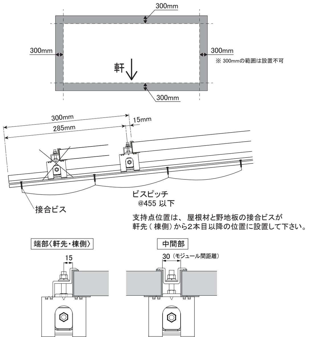
【 モジュールの固定位置 】 ※6点・8点固定は、ハゼピッチによっては施工できない場合があります。
