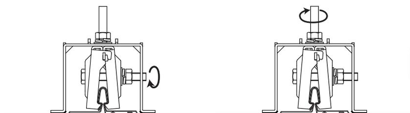
先に横側ナットを締め付けます。
