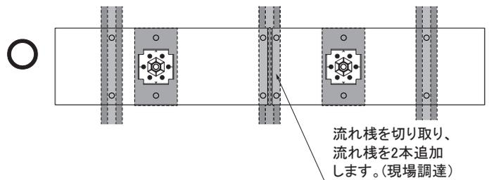
※多雪施工(6点固定)で瓦用補強板3が干渉する場合は余分な部分を切り取ってご使用ください。
