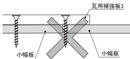
● 瓦用補強板3と小幅度板の隙間がそろわないようにしてください。積雪や暴風等で金具部に局部的に力が加わり、小幅度板の継ぎ目がずれてルーフィングが破れ、雨漏りの原因となるおそれがあります。
