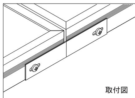
※ 全てのラック間アース金具が取付完了後、最後に必ず導通が取れているかの確認を行ってください。
