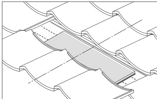
置いた瓦用補強板3の、垂木位置に木ねじW65を図のように4本打ち込んで瓦用補強板3を固定してください。
