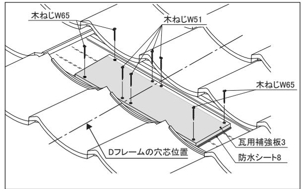
瓦用補強板3にDフレームの穴芯位置の線を引いてください。
