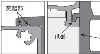
ES金具とアース台座の間に隙間が生じないように押し当ててください。
