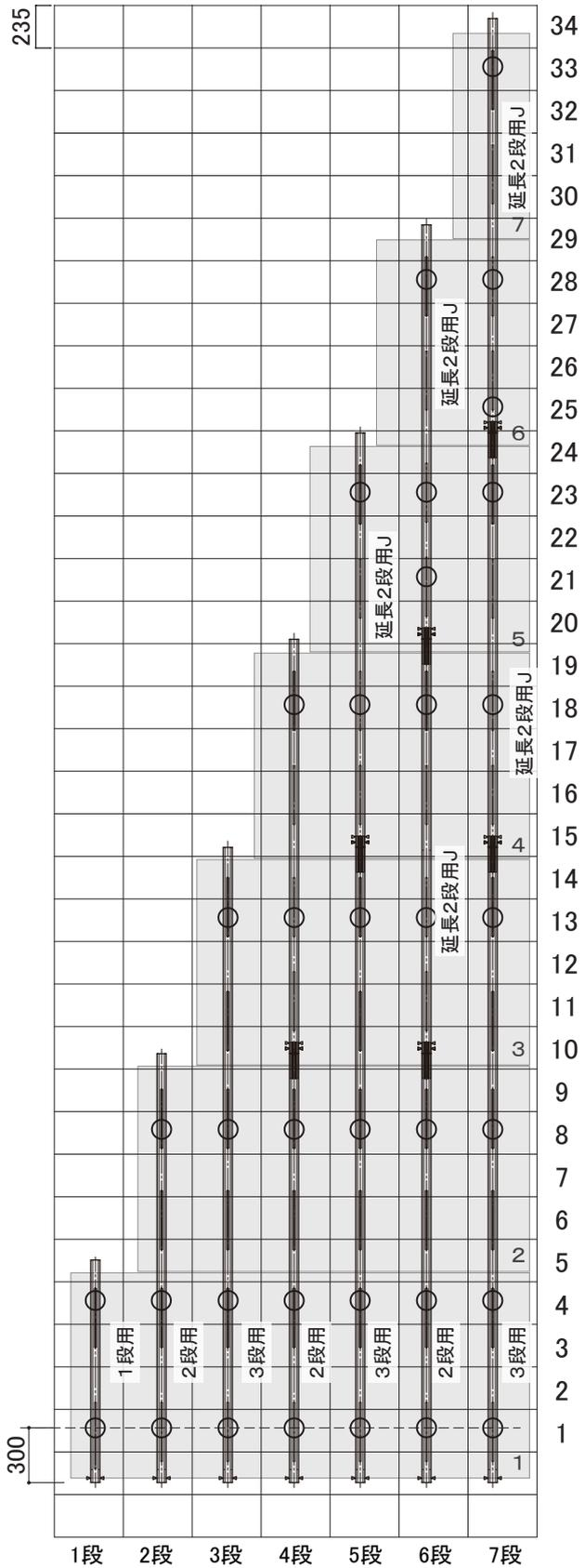
【 Dフレーム支持点位置例 53B 】 ※軒側端部 300mm の場合
