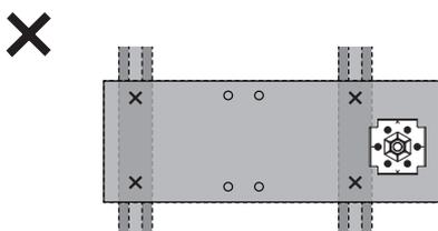
〔 瓦用補強板3の継ぎ目にアンカーベースがある場合、設置不可 〕
