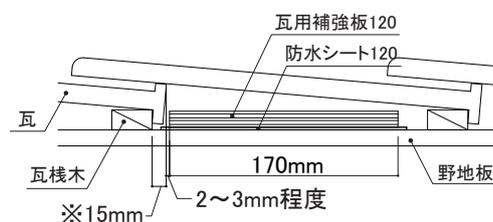
防水シート120上に瓦用補強板120を下側の瓦尻から2~3mm離し配置してください。
