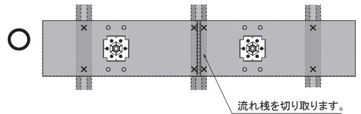
※多雪施工(6点固定)で瓦用補強板3が干渉する場合は余分な部分を切り取ってご使用ください。
