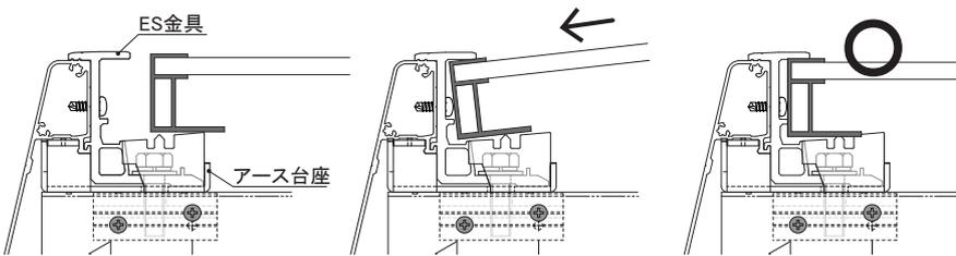
アース台座の傾斜面にPVモジュールを置きます。
