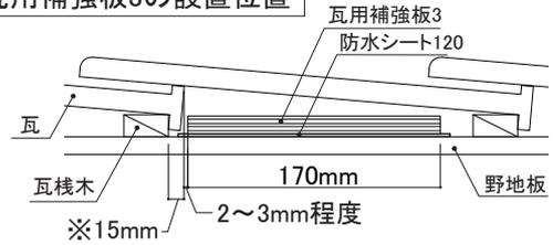
防水シート120上に瓦用補強板3を下側の瓦尻から2~3mm離し配置してください。
