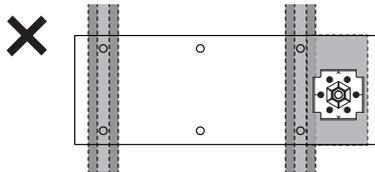
〔瓦用補強板3の継ぎ目にアンカーベースがある場合、設置不可〕
