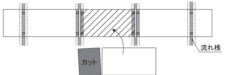
〔瓦用補強板3の端にアンカーベースがある場合、設置不可〕
