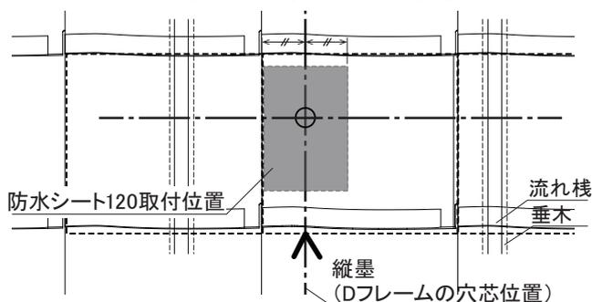
取り付け位置に、防水シート120の剥離紙を剥がし貼付けてください。
