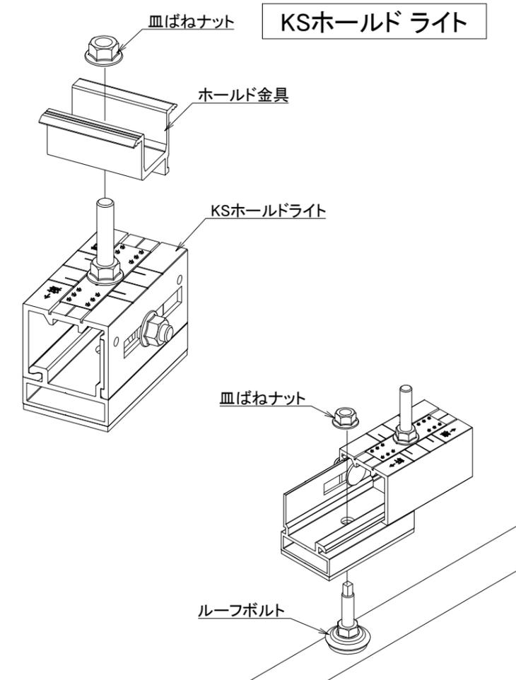
〈適合屋根材: 重ね式折板屋根材〉
