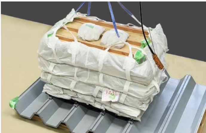
※機械的静荷重試験 (11250Pa 載荷時)
